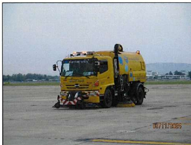
รูปที่ 3.3-4 รถดูดฝุ่นของโครงการภายในพื้นที่เขตปฏิบัติการบิน ในช่วงที่มีการขึ้น – ลงของอากาศยาน
